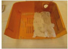
[F. 14] Limpieza por medio de compresas de algodón empapado en agente tensioactivo no iónico (Dehyphon a 2% en agua desionizada).
